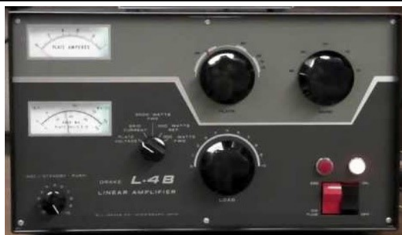
L-4B Linear Amplifier (2x 3-500z Eimac Tubes)
